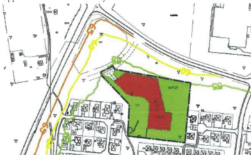
Bild: Bullernivåer för prognosår 2035, utdrag ur planbeskrivning för detaljplan för del av Fjugesta 1:2 (2014-03-27)
